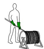
PER LO SFILAMETO DI CAVI DI ACCIAIO E NON USARE SEMPRE GUANTI E DI PROTEZIONE
