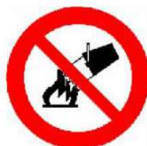
VIETATO SPEGNERE CON ACQUA
