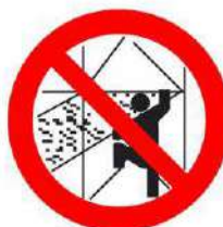
VIETATO ARRAMPICARSI SUI PONTEGGI
