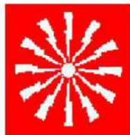
PULSANTE DI ALLARME ANTINCENDIO
