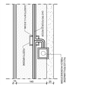
SEZIONE TIPO CAVIDOTTO
