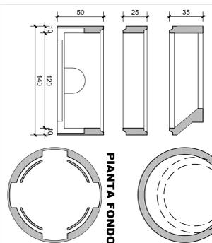
SEZIONE TIPO CAVIDOTTO
